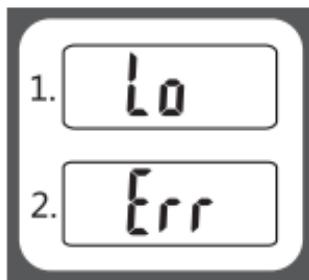
1. Batterie faible. Remplacez la batterie.
